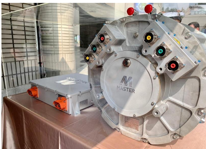
▲成運自主設計研發製造的中央直驅馬達，具備450kW峰值功率。
