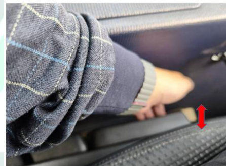
上下扳動可調整 座椅高度
