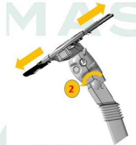
旋轉②旋鈕，調整方向盤前後位置
